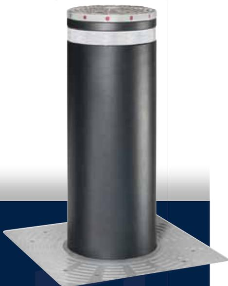
1. Hochsicherheitspoller, getestet und zertifiziert nach der amerikanischen Norm ASTM F 2656-07 M30 P1 (der Poller stoppt einen LKW mit 6,8t bei einer Geschwindigkeit von 50km/h)
